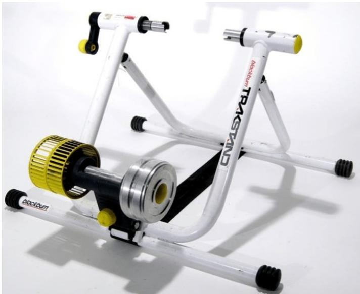
3. **Resistenza idraulica.** Si tratta di un sistema molto efficace perché la resistenza offerta dal fluido somiglia a quella della strada. Il fluido è solitamente costituito da olio industriale che sopporta meglio il calore generato durante la pedalata. Come per il sistema a ventola, più veloce è la pedalata maggiore è la resistenza.
