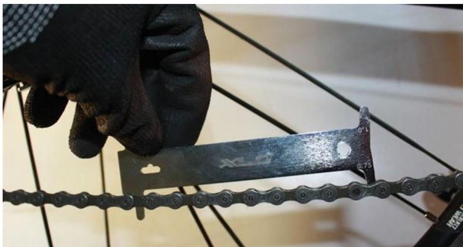
Un altro strumento che aiuta a comprendere lo stato di usura della catena è il "CC2 chain checker" della Parch Tool.
