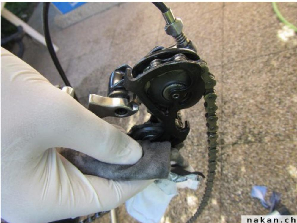
Una volta ben sgrassata la trasmissione passarci sopra con la spugna, badando bene a mettere un bel pò di schiuma su catena, deragliatori e pedali.
