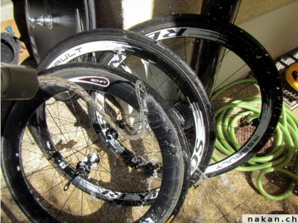
NOTA : il momento in cui le ruote sono pulite e sul punto di asciugare è quello ideale per verificare il loro stato generale così come l'usura dei copertoncini.
