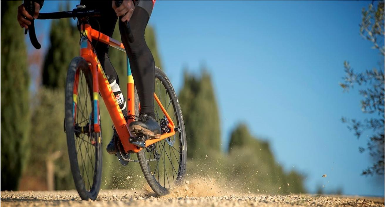
In generale le BDC sono realizzate per permettere al ciclista di avere una posizione più “lunga”, più “bassa” e quindi più aerodinamica mentre **le gravel sono più corte e più “verticali” per permettere un maggiore comfort e una maggiore efficienza di guida sui terreni sterrati.**
