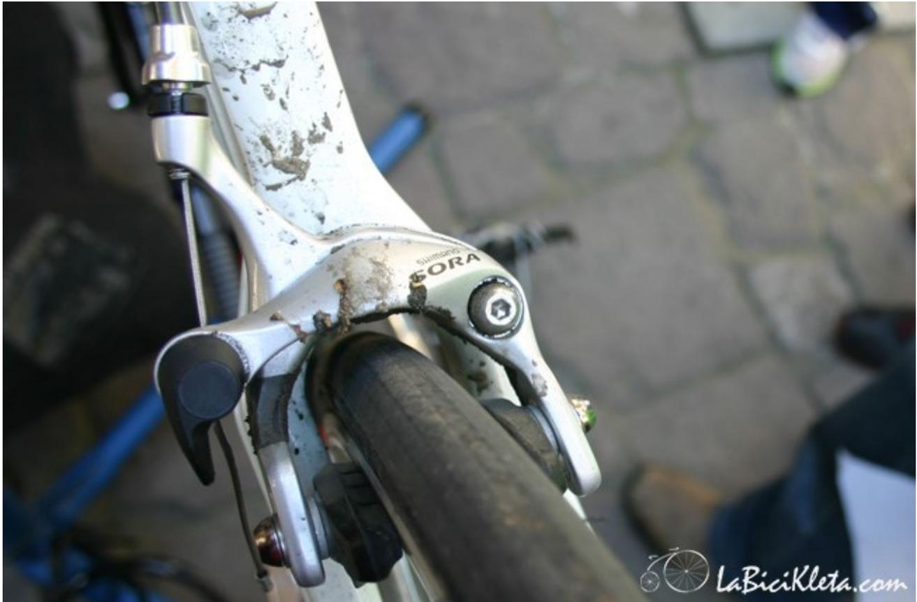
*Questo freno ha una vite centrale che serve da perno per uno dei bracci e la leva. La vite che si vede sul lato destro di questa immagine è il secondo perno asimmetrico.*
