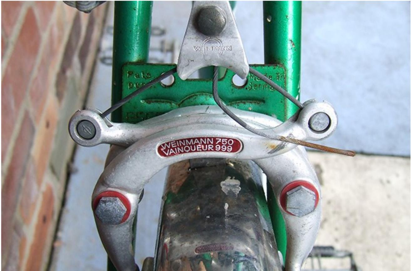
*Nell'immagine possiamo vedere le due viti che tengono ciascun braccio alla base del freno e, che a loro volta, funzionano come perni. Allo stesso modo, è possibile vedere il cavo incrociato collegato al cavo centrale.*
