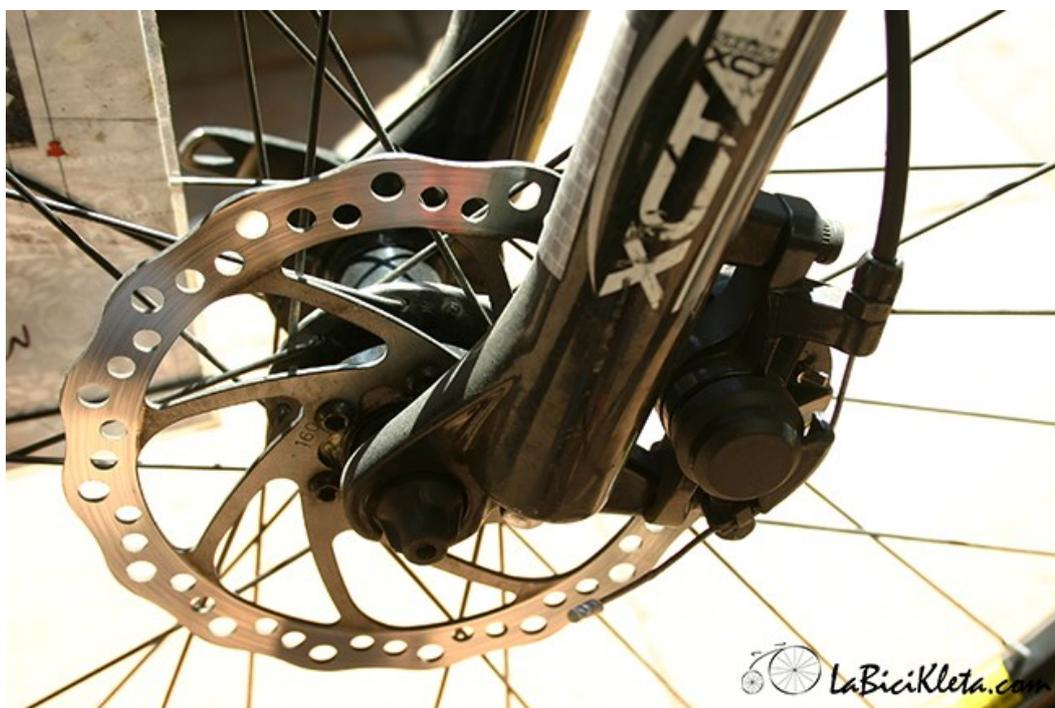
*Qui possiamo vedere un sistema di frenatura meccanica a disco. È importante osservare come la pinza viene fissata alla forcella mediante supporti speciali.*
