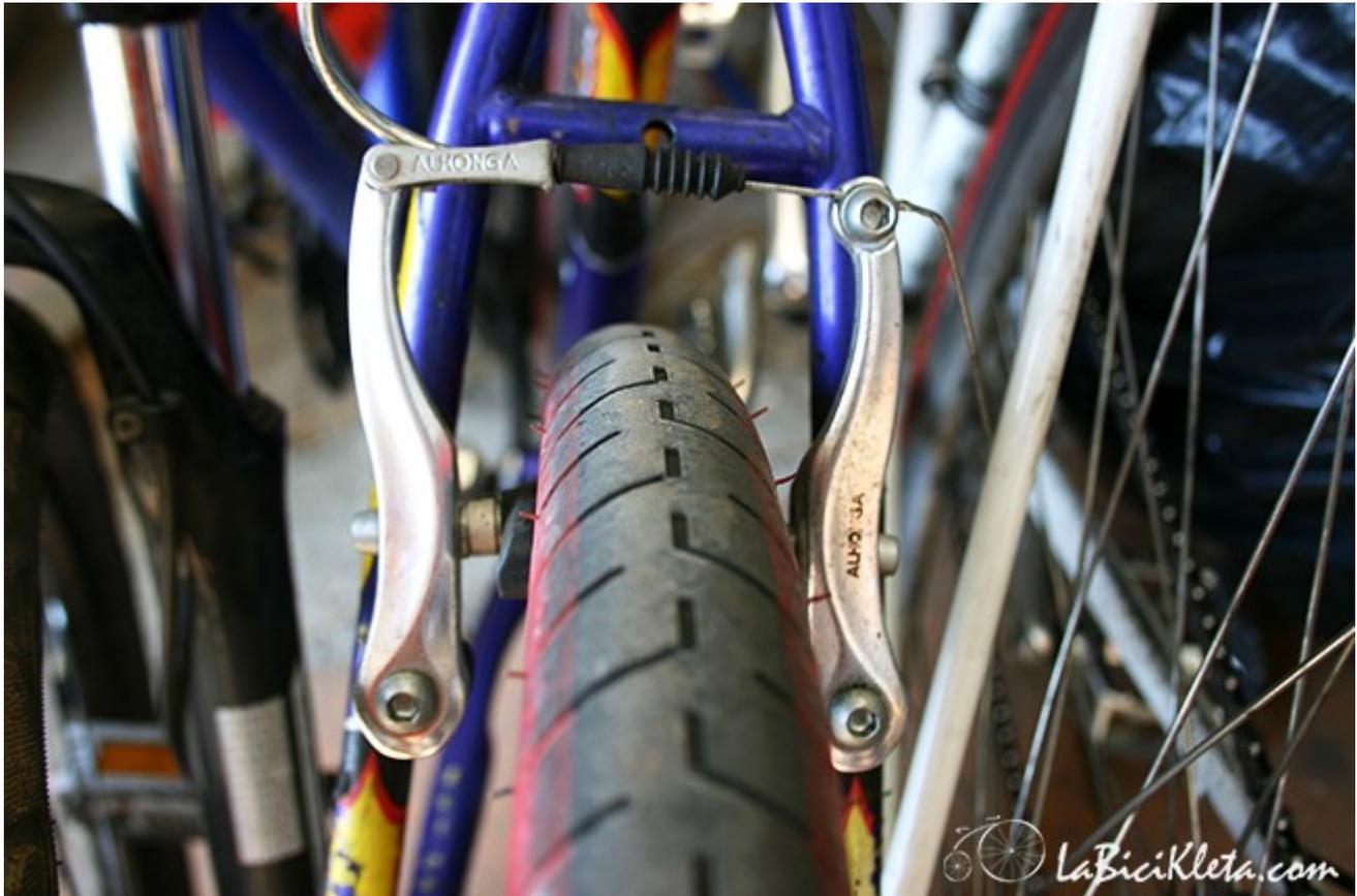
*Possiamo vedere come il braccio sul lato sinistro sia fissato al terminale di rivestimento tramite un sistema di "sgancio rapido", mentre il braccio destro tiene il cavo.*
