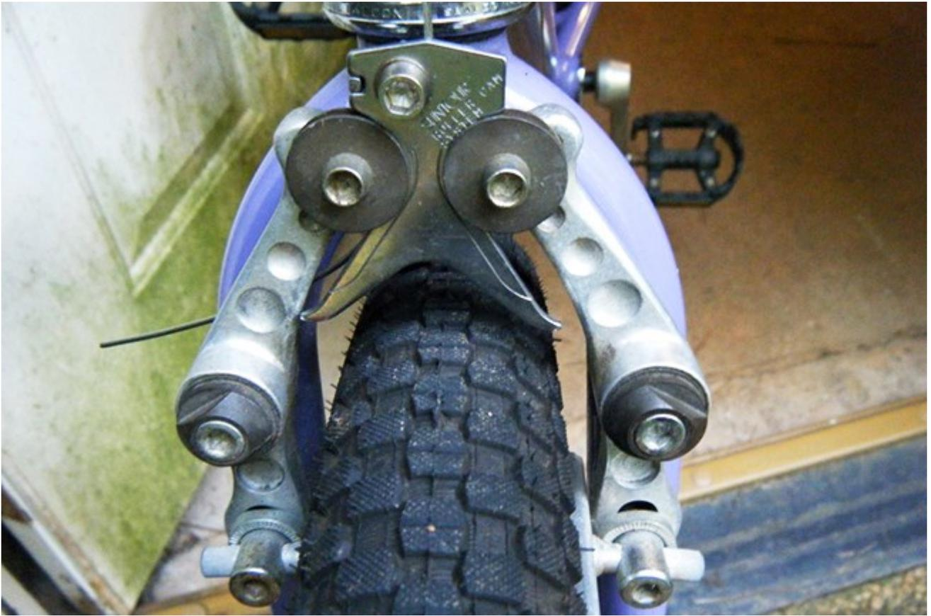
*Possiamo apprezzare la piastra a forma di coda di pesce. Questa è la leva che quando si muove verso l'alto apre la parte superiore dei bracci e di conseguenza fa premere i pattini contro le facce laterali delle ruote. Quelli che sembrano due rondelle nella parte superiore del freno sono i rulli che consentono il movimento regolare della leva e permettono anche di mantenerla allineata.*
