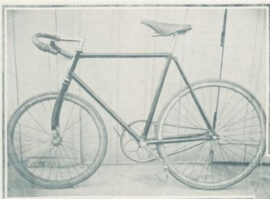
La bicyclette du stayer. Le cadre très court et la fourche cintrée en dedans lui permettent de coller plus près de son engin entraîneur.
