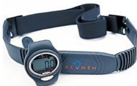
Il suo funzionamento è semplice: un emettitore posto attorno al torace dotato di elettrodi che captano i segnali del cuore e li trasmettono sotto forma di onde radio ad un recettore che può essere portato ai polsi oppure su un supporto fisso (manubrio della bici). L'utilizzazione del cardio non provoca alcun problema e l'atleta è interamente libero di fare ogni tipo di movimento.
